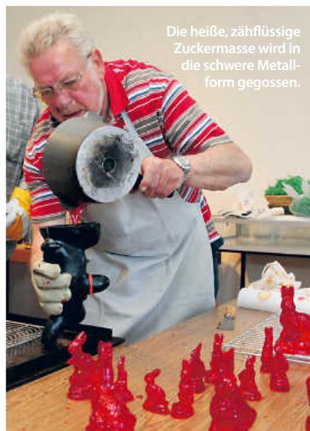
Die heiße, zähflüssige Zuckermasse wird in die schwere Metallform gegossen.
